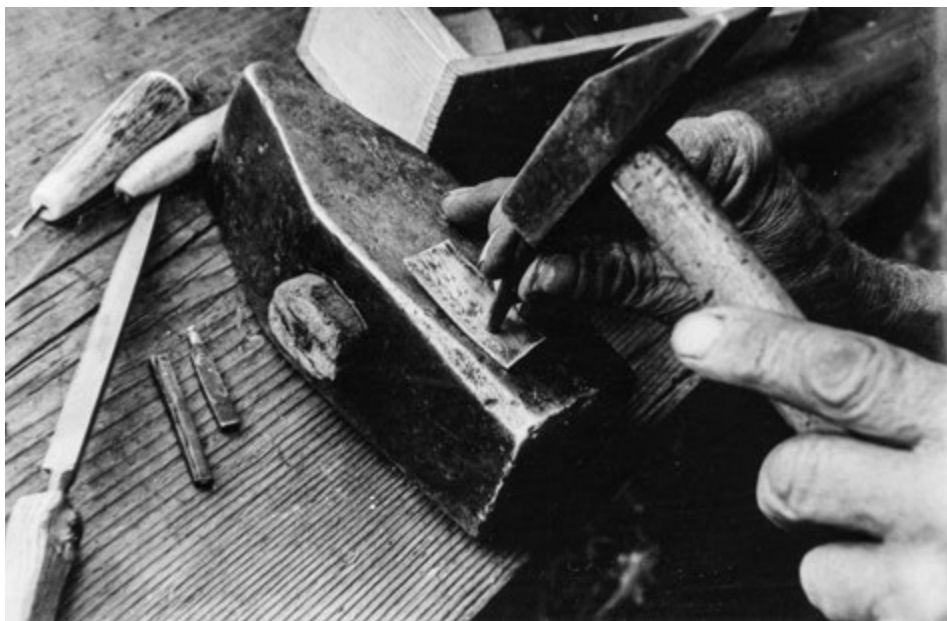
Fig. 21. Poansonarea rozetelor pe tabla de bronz. Foto Adrian-Silvan Ionescu
