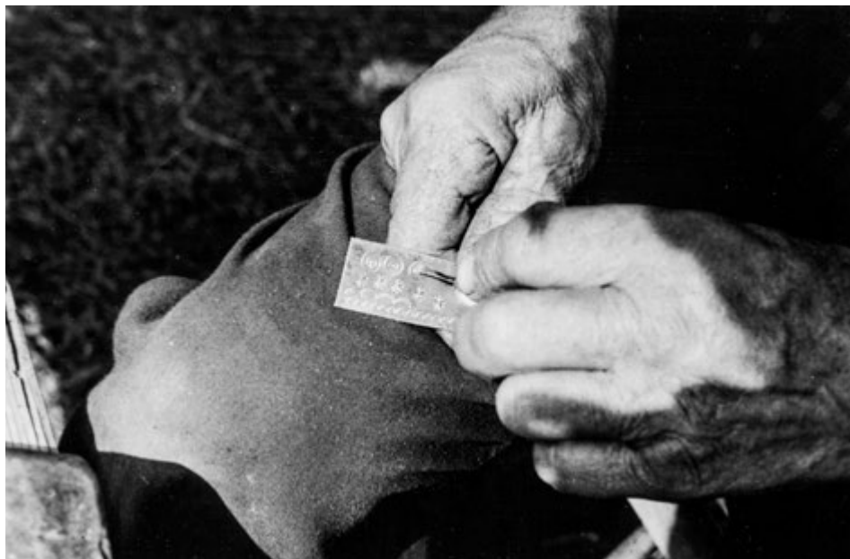
Fig. 22. Trasarea de cerculețe pe tabla de bronz. Foto Adrian-Silvan Ionescu
